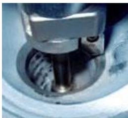
Рис. 1. Кольцо седла клапана фрезеруется
