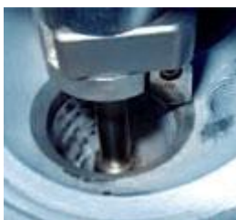
Рис. 4: Для облегчения монтажа кольца седла клапана охлаждаются при помощи жидкого азота.
