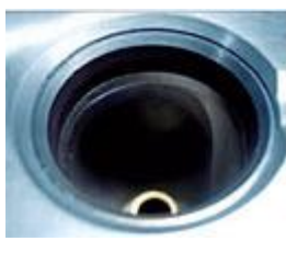
Рис. 6: Оптимальный результат монтажа с новым кольцом седла клапана.
