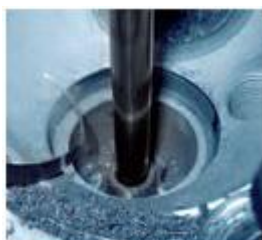
Рис. 2: После фрезерования виден остаток кольца.
