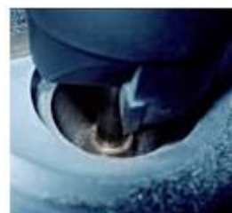
Рис. 3: Фрезерная головка для обработки штатного места кольца седла клапана.
