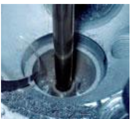
Рис. 5: Треснувшая перемычка – результат слишком большого перекрытия.
