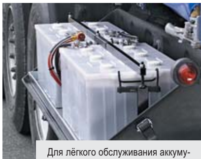
Аккумуляторный ящик, размещённый на противоположном брусе
