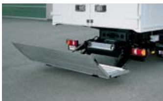
Раскладка конечной части платформы производится вручную с помощью разгрузочных пружин.
