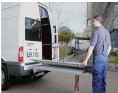
Гидравлически открывается и раскладывается от руки
