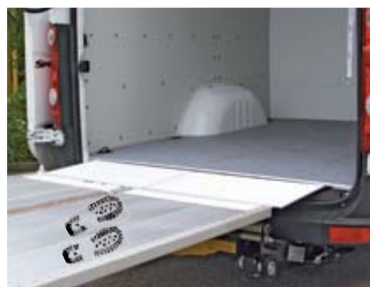
VanBridge соединяет пол фургона и платформу. Разница по высоте 12 мм в стандартном исполнении пола фургона.
