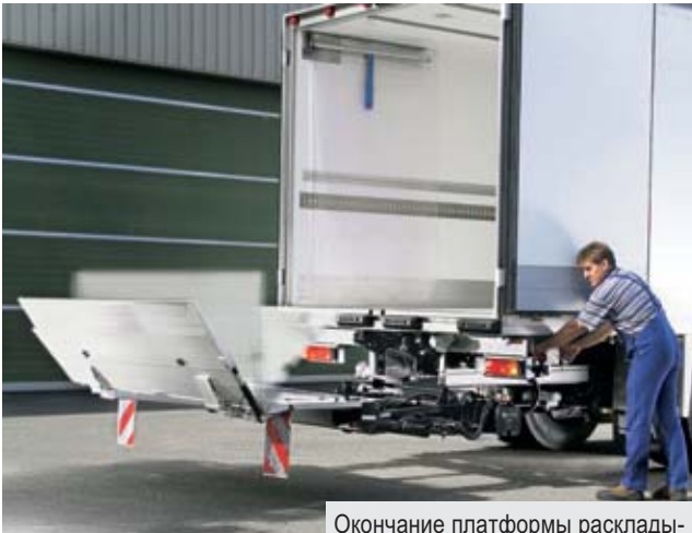
Окончание платформы раскладывается гидравлически (начиная от высоты платформы 1810 мм).
