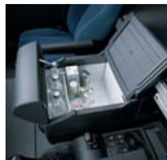
Изотермический бокс, по желанию - с охлаждением
