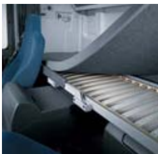
Основание спального места из деревянных планок
